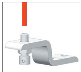
Passage du conducteur dans l'équerre de reprise au sol
