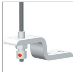
Fixation du conducteur avec le tendeur
