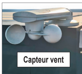
Capteur vent posé sur le bandeau ou sur un mur à proximité et bien sûr à un endroit exposé au vent
