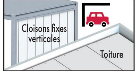
TOITURE & CLOISONS : multi-panneaux sandwich aluminium avec isolant d'épaisseur totale 62 mm, largeur panneau 500 mm
