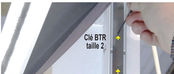
Insertion des coulisses sur le coffre
