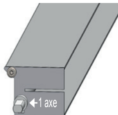
Lame de fin arrière réduite en largeur Bloqueur nécessaire
