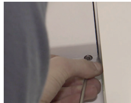
Insérer le capot dans la glissière, abaisser le capot et visser de chaque côté à l'aide des vis M5
