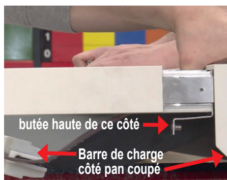
Insertion des coulisses sur le coffre
