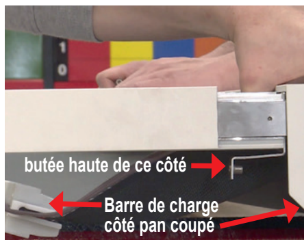
Insertion des coulisses sur le coffre
