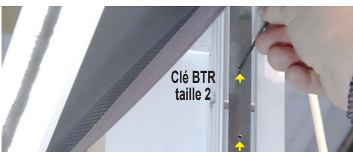
Insertion des coulisses sur le coffre
