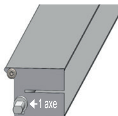
Lame de fin arrière réduite en largeur Bloqueur nécessaire
