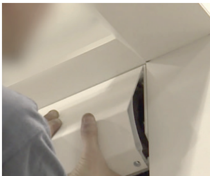
Insérer le capot dans la glissière, abaisser le capot et visser de chaque côté à l'aide des vis M5
