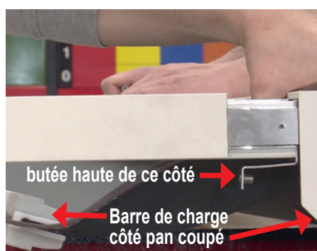
Insertion des coulisses sur le coffre
