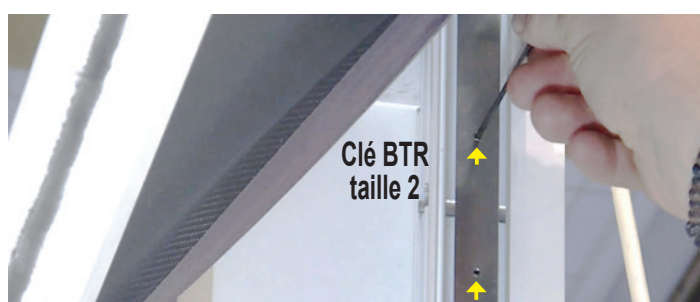
Insertion des coulisses sur le coffre
